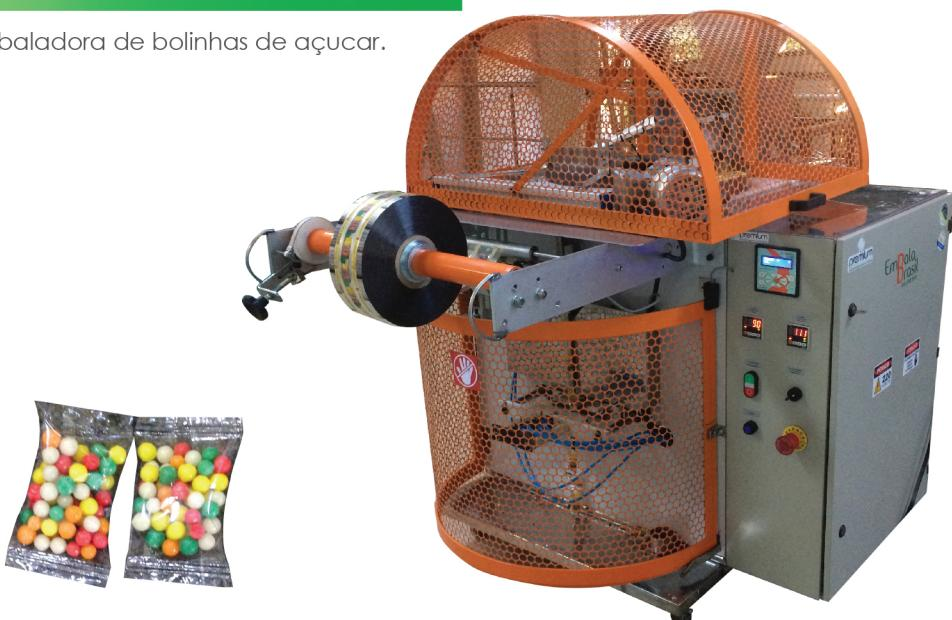
Foto: Máquina adquirida pela Angeumar Mini Brinquedos, embaladora de bolinhas de açúcar.
