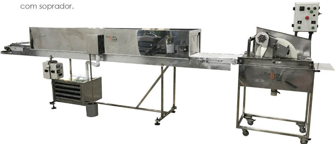
Foto: Máquina adquirida por Biscoitos ML, cobridera de biscoitos.
