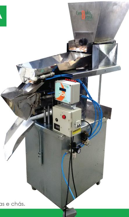
Foto: Máquina adquirida por Nilton, para pesar balas e chás.
